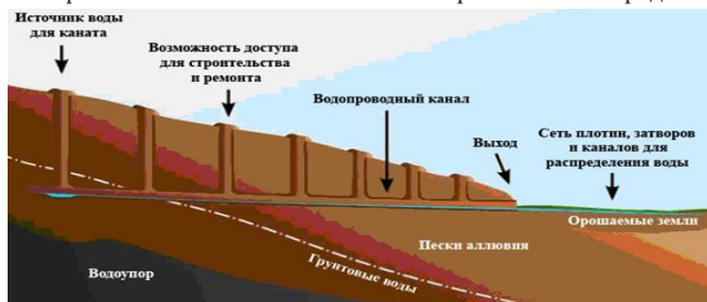
Рис. 13. Схема устройства подземного канала-каната
