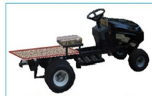
Рис.2. Миниэлектротрактор с двигателем ДК-908А
