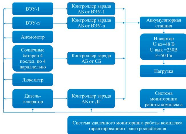
**Рис. 3. Структурная схема комплекса электроснабжения на ВИЭ с многомодульных ВЭУ, солнечных батарей и системой контроля ВСДЭС**
