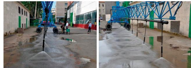
**1-расм. ТИҚҲММИ ва “Технолог” АЖ томонидан яратилаётган ёмғирлатиб сугориш машинасининг ишлаб турган ҳолатдаги умумий кўриши**
