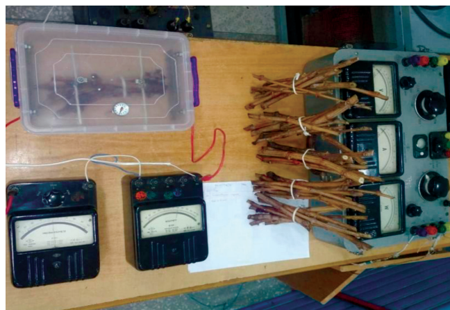
2-расм. Узум қаламчаларига электр ишлов бериш жараёни
