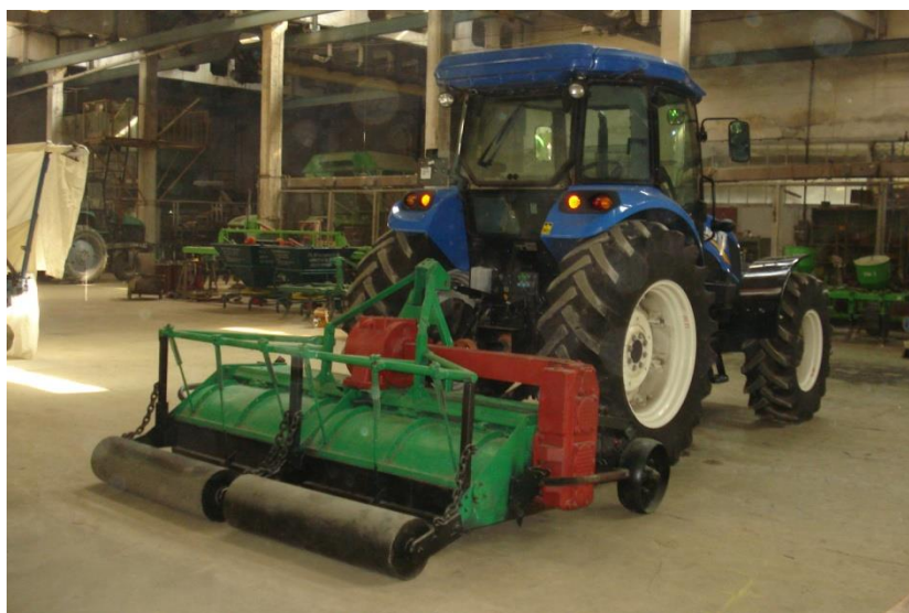
Рис. 1. Комбинированная машина, снабженная фартуком-выравнивателем, работающим совместно с кожухом ротора в режиме клапана
