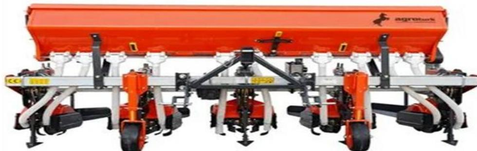
3-расм. KXY-4Б ва фрезерли культиватор
