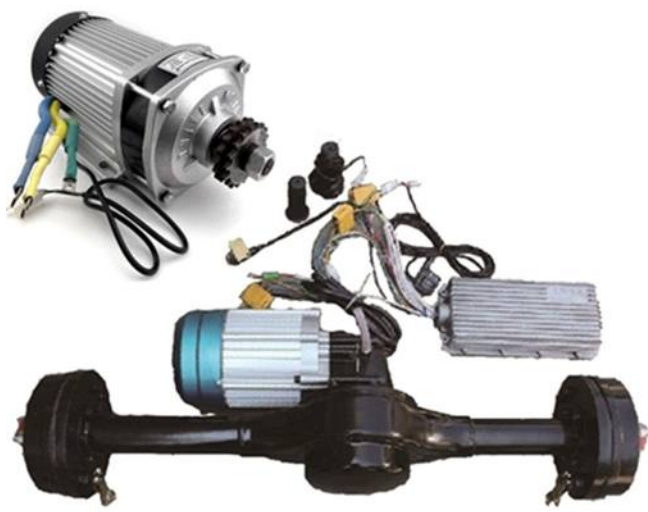
7-rasm. Mobil elektromexanik qurilmaning elektr yuritmasi
