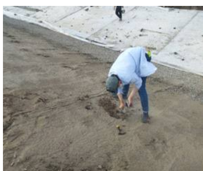
Рис. 9. Взятие пробы для определения плотности грунта
