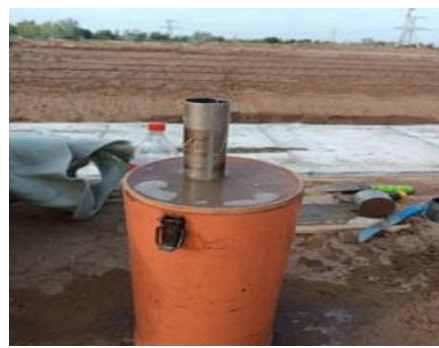
Рис. 10. Определение влажности и плотности с помощью прибора Ковалева.
