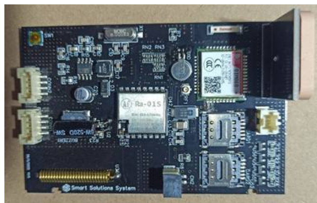
9-расм. Ақлли сатҳ сенсорнинг саноат намунасининг платаси
