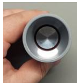
а) 1-расм. MB7580 маркали ультратовушли масофа ўлчагичи: а – юқоридан кўриниши; б – ёнидан кўриниши; в – пастдан кўриниши
