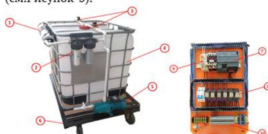
Рисунок 3. Прототип устройства очистки оросительной воды от высокого содержания солей
