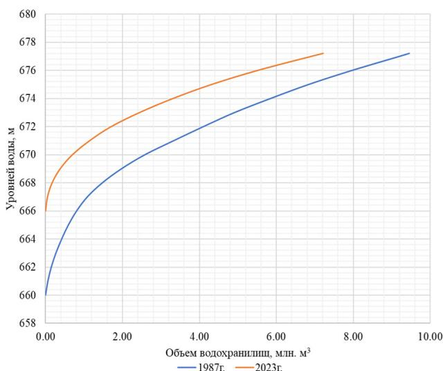
Рис. 7. Кривые зависимости объема Калкаминского селеводохранилища от уровня воды (2023 г.)
