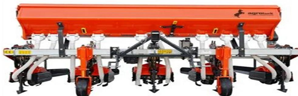
3-расм. КХУ-4Б ва фрезерли культиватор
