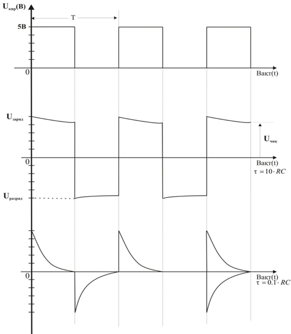
4-расм. RC дифференциалловчи схеманинг чиқиш сигнали
