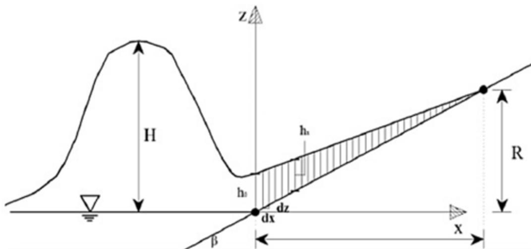
1-rasm. To'liqlik ko'tarilgan suv oqimining sxematik ko'rinishi
