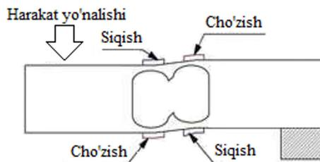
3-rasm. Kuchlanish o'lchagichidagi yukning mexanik ta'siri ostida egiluvchan taglikning deformatsiyasi
