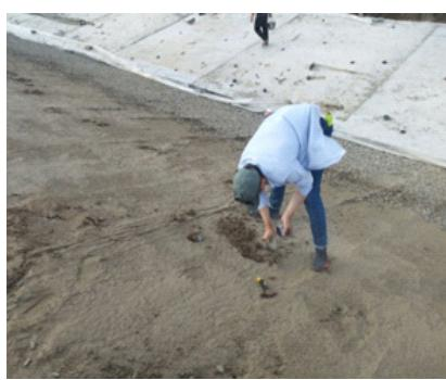
Рис. 9. Взятие пробы для определения плотности грунта
