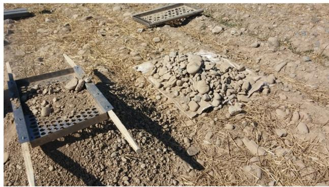
**5-расм.** Тўрт хил фракцияларга (ўртача диаметри 0,03–0,3 м), ўртача тошли (ўртача диаметри 0,3–0,6 м), йирик тошли (ўртача диаметри 0,6–1,0 м), ўта йирик тошли (ўртача диаметри 1,0 м. дан катта) ажратиш жараёни.
