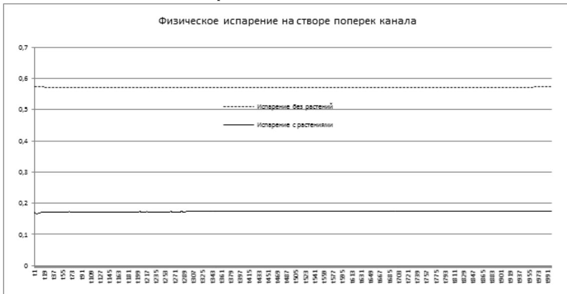
Рис. 7. Сравнение потерь на испарение поперек канала для случая наличия растительных полос и без них
