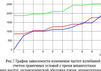
Рис.7 График зависимости изменения частот колебаний с учетом граничных условий с тремя шлангутами
