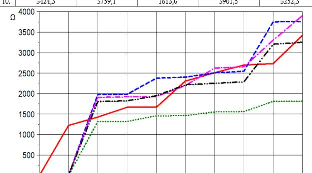
Рис.12. Графики изменения частот собственных колебаний цилиндрической оболочки, в зависимости от количества шлангутов
