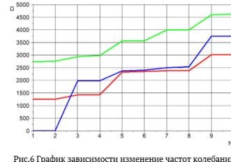
Рис.6 График зависимости изменения частоты собственных колебаний с четырьмя шлангутами
