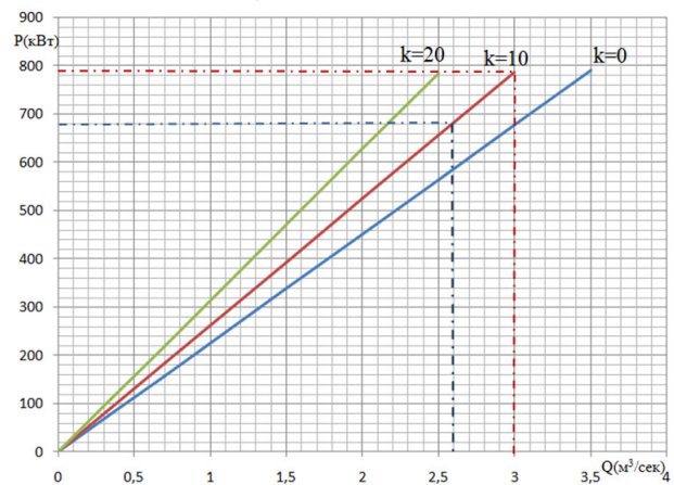
6-расм. Аму-Бухоро машина канали Олот туман бошқармаси тасарруфидаги Жондор-1 кўтарма насос станциясининг 1та насос агрегати қувват истеъмоли графиги
