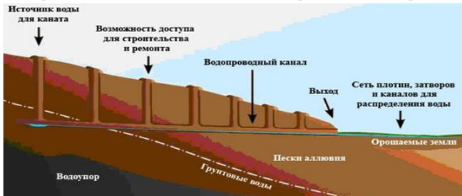
Рис. 13. Схема устройства подземного канала-каната
